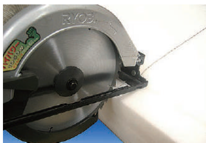
図2 厚いボードタイプは、 電動丸ノコの刃を裏返して装着しカット します。繊維がからむ事無くカットできます。
