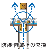
防湿・断熱上の欠損
