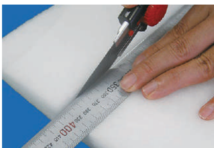
図1 薄いボードタイプは、オルファ社の超鋭角刃特選黒刃をご使用下さい。
